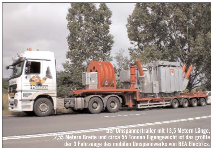
Alle 3 Teile des mobilen Umspannwerkes von BEA Electrics verfügen über die Straßenzulassung und können in kurzer Zeit an jedem Ort zum Einsatz gebracht werden.
